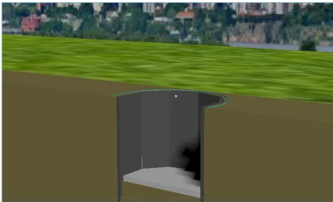
Figura 27. Colado de la losa de fondo
