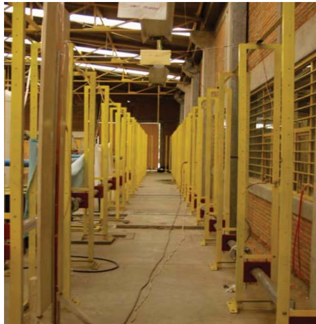
Figura 3.5: Sección de pruebas. En la imagen se aprecia la extensión de la tubería.
