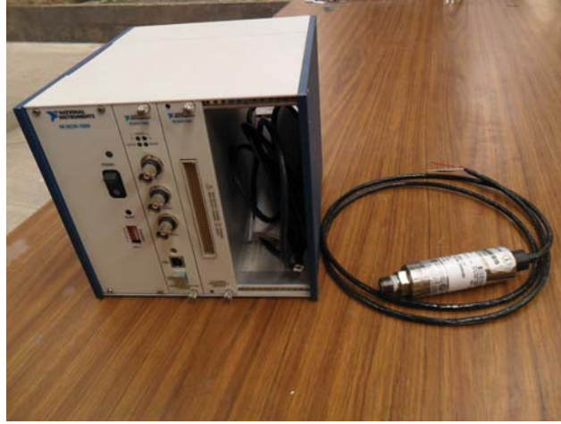
Figura 3.6: Subsistema de medición. El equipo de adquisición de datos NI-DAQX de la marca National Instruments a la izquierda; a la derecha se muestra un transductor de presión Honeywell serie FP2000.
