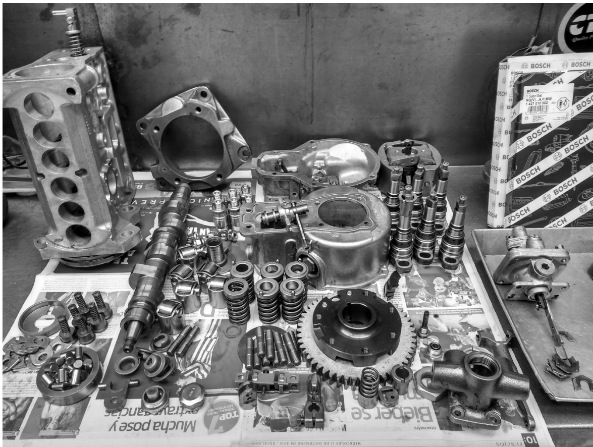
Imagen 3.1. Bomba diésel PES desarmada. Elaboración propia.
