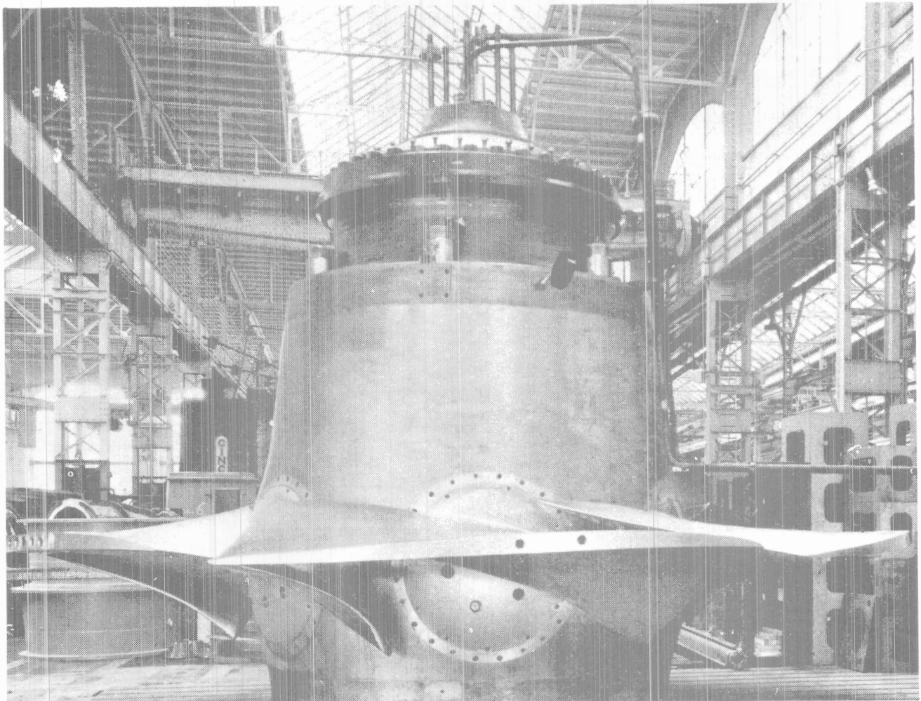
Figura 7.7. Rodete Kaplan (posición cerrado) (Cortesía Escher Wyss)
