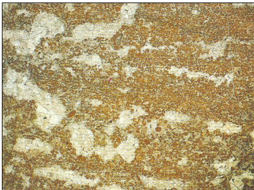
Figura 2.32 Porosidad fenestral. Replica en acetato teñido, caliza de Woo Dale, carbonífero inferior, Derbyshire, Inglaterra, Gran Bretaña; aumento: 7X, LPNA (tomada de Adams, 1997).
