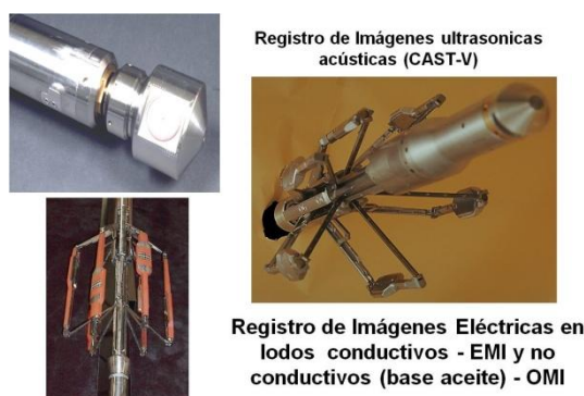
Figura 5.53 Fotografía de las herramientas que se utilizan para el registro de imágenes. En las ultrasónicas acústicas (CAST-V) se utiliza la herramienta de la parte superior izquierda, la herramienta que se utiliza para el registro de imágenes eléctricas en lodos no conductivos base aceite (OMI) es la imagen inferior izquierda; la herramienta que se utiliza para el registro de imágenes eléctricas en lodos conductivos (EMI) es la imagen de la derecha (tomada de Halliburton: Imágenes y echados con ejemplos, 2004.)
