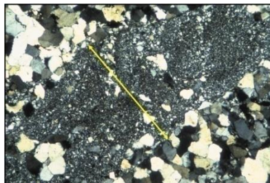
Figura 5.11 Microfotografía de una fractura gouge-filled o banda de deformación en una sección delgada, de las areniscas Nugget, del campo Ryckman Creek (tomada de internet del curso de Nelson: Elsevier Geologic Analysis of Naturally Fractured Reservoirs, 2001).
