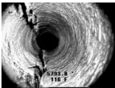
Figura 5.70 Imagen en la que se muestra una fractura natural en calizas, obtenida con video (tomado de Halliburton: Fracture Identification, 1998).
