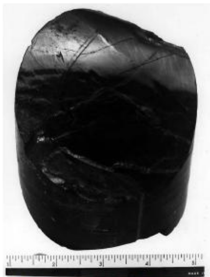
Figura 5.24 Fotografía que muestra una fractura slickensided o espejos de falla en lutitas. La muestra es del Devonian Second White Specks, Alberta, Canadá (tomada de Nelson, 2001).
