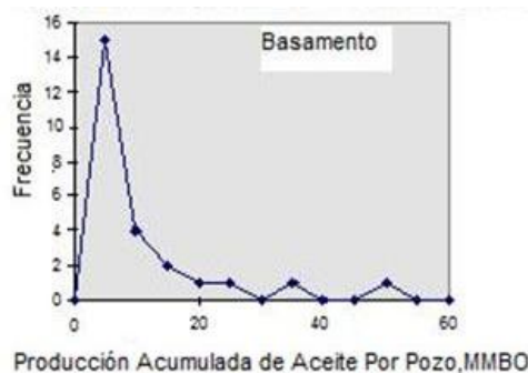
Figura 6.4 Diagrama que muestra la frecuencia de la producción acumulada de aceite por pozo, en millones de barriles de aceite, del basamento de granito del yacimiento naturalmente fracturado del Campo La Paz, de la Cuenca Maracaibo, de Venezuela. La distribución está altamente sesgada (en papel log-normal presenta forma de campana) es típica de las fracturas dominando a los yacimientos. Note que la mayoría de los pozos tienen una producción acumulada de aceite de alrededor de 5 millones de barriles de aceite (MMBO), mientras que unos pocos tienen una producción acumulada de aceite de 7 a 10 veces esa cantidad (tomada de Nelson, 2001).
