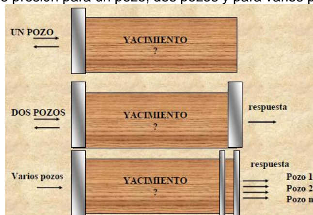
Figura 5.82 Esquema que muestra los arreglos que se pueden seguir para las pruebas de presión con uno, dos o varios pozos (tomado de CAP-4-REGISTROS GEOFISICOS, del curso de PEMEX. 2003).
