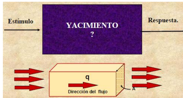
Figura 5.80 Esquema que muestra como se genera un estímulo al yacimiento que genera una respuesta en la que se puede medir la variación de la presión (tomado de CAP-4-REGISTROS GEOFISICOS, del curso de PEMEX. 2003).
