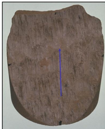
Figura 5.17 Ejemplo de la superficie de una fractura slickensided o espejos de falla o pulida, y su morfología, del campo Ryckman Creek, en la arenisca Nugget, en un núcleo de 4 pulgadas de diámetro (tomada de internet del curso de Nelson: Elsevier Geologic Analysis of Naturally Fractured Reservoirs, 2001).
