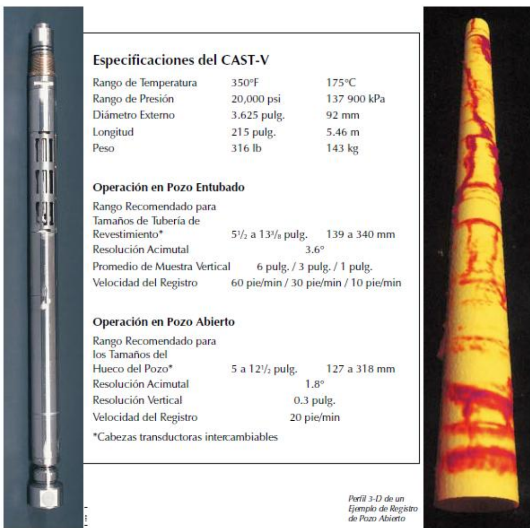
Figura 5.57 Fotografías que muestran la herramienta CAST-V y las características que debe tener el pozo perforado, una imagen en 3-D cilíndrica de la imagen del CAST-V (tomado de: EL-1101, 1995).
