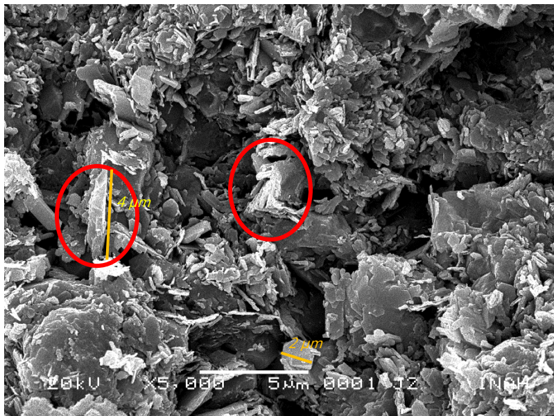
Fig. 4.30. Imagen de la muestra M4 con MEB, en donde se observa la morfología y tamaño (variable) de las láminas de caolinita. En la parte inferior izquierda se puede observar caolín aglomerado. La forma del caolín es variable, se pueden observar pocas láminas pseudo hexagonales, fibras (halloysita) y láminas enrolladas (círculo rojo). El tamaño de las láminas varía de tamaño, menor o igual a 4 \mu\text{m} .
