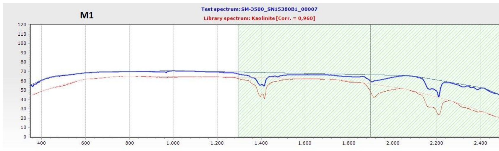
Fig. 4.32. Espectro SWIR de la muestra M1 de Huayacocotla, coincidente con la ficha Kaolinite KL502 (pxl) de la base de datos USGS, con una correlación de 0.960.
