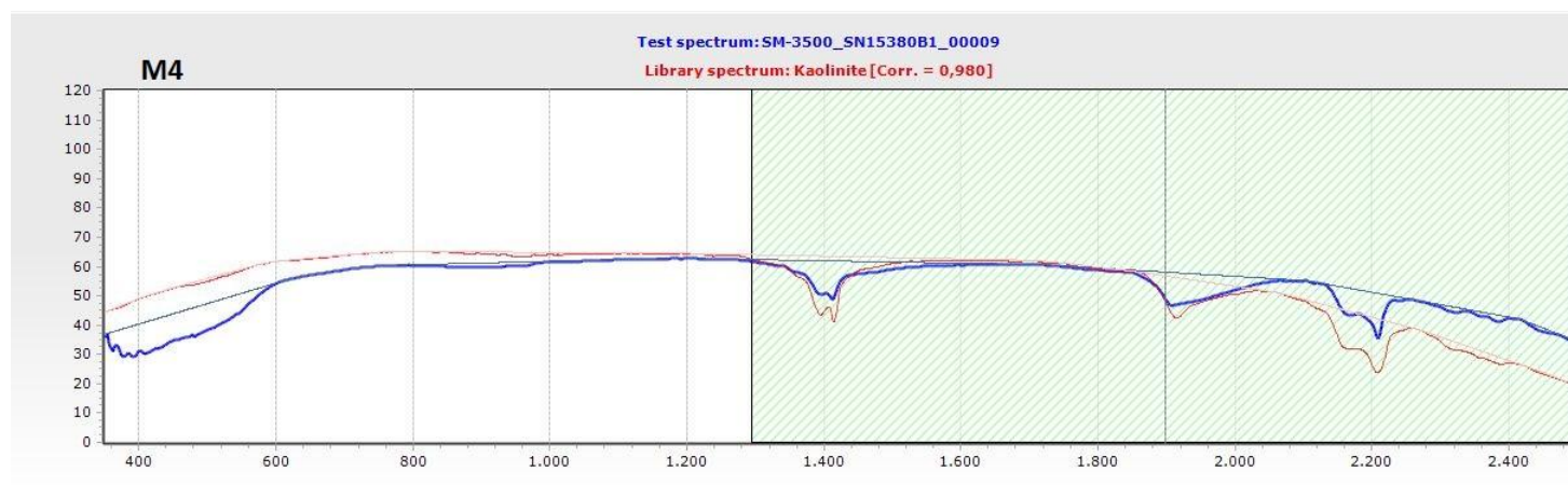
Fig. 4.35. Espectro SWIR de la muestra M4 de Huayacocotla, coincidente con la ficha Kaolinite KL502 (pxl) de la base de datos USGS, con una correlación de 0.980.
