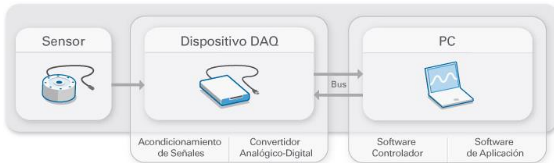
Figura 3.14. Partes de un sistema DAQ.
