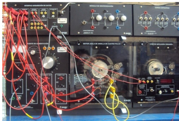
Fig. 2.19) Equipo conectado para experimentos con motor jaula de ardilla.
