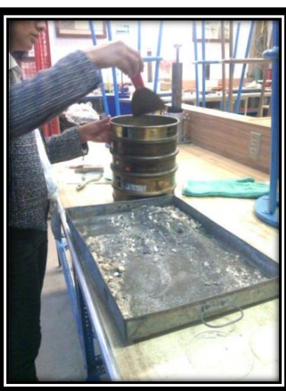
Figura 34. Colocación del material sobre el juego de mallas
