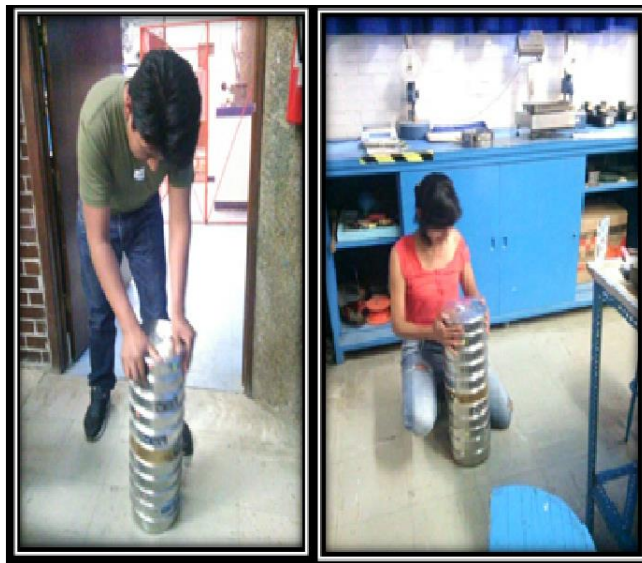
Figura 35. Vibrado del material
