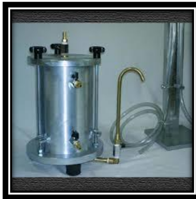
Figura 36. Permeámetro utilizado en el laboratorio
