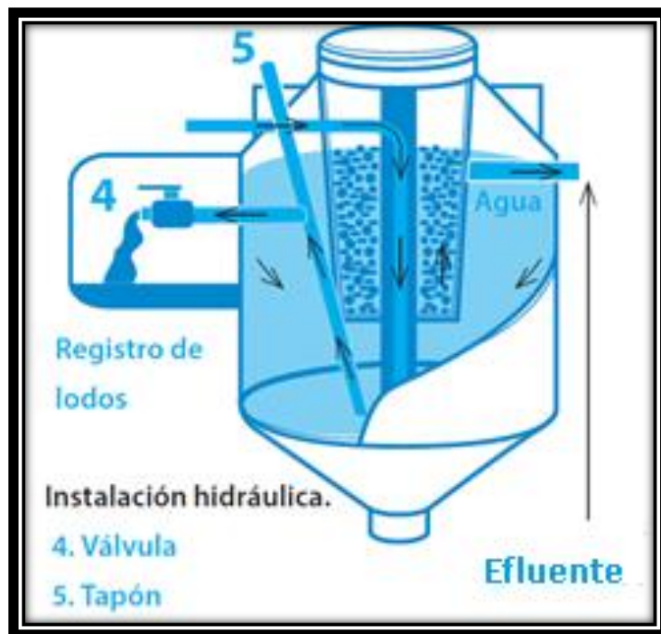
Figura 43. Mantenimiento del biodigestor. Fuente: Manual Rotoplas.
