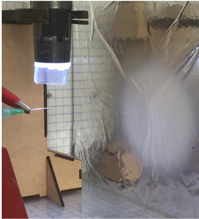
Figura [4.13]. Microscopio encima de la aguja de la jeringa durante el proceso.
