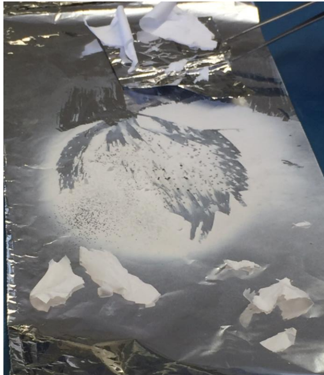
Figura [6.22]. Andamios de fibra siendo retirados con las pinzas.
