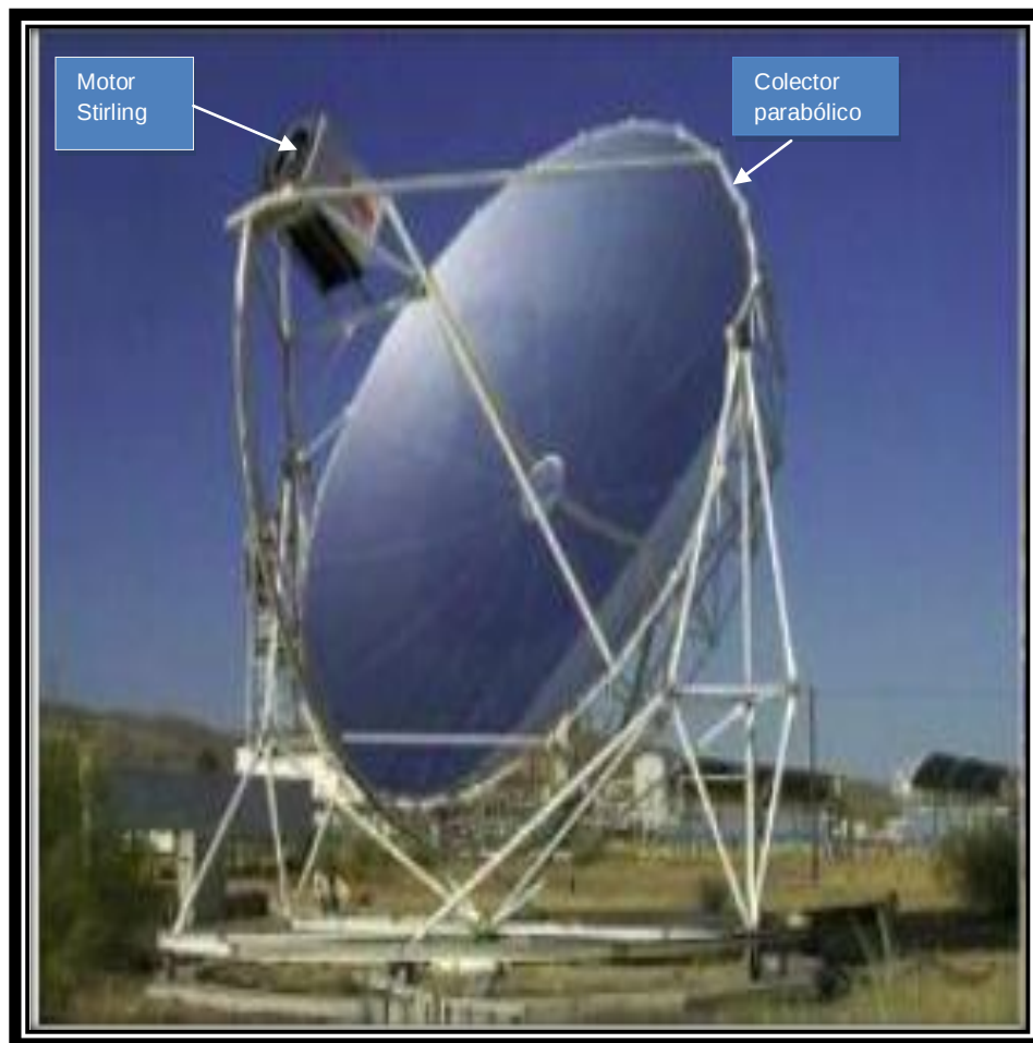
Figura 2.13 Fotografía de un colector solar parabólico con motor Stirling (Estrada, 2013)
