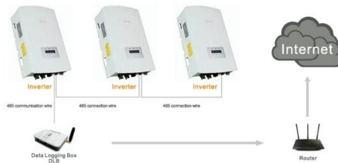
Figura 8.26 Esquema del sistema de monitorización, equipos certificados y ecosistema Solis Ginlong.
