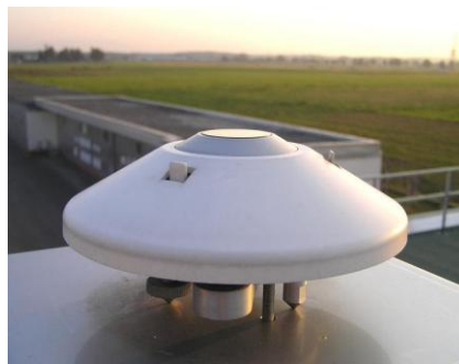
Figura 2.5 Pirgeómetro. Medidor de onda larga
