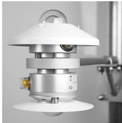
Figura 2.6 Piranómetro UVB de Kipp & Zonen. Medidor del índice de radiación UV.
