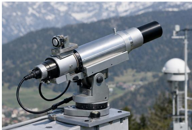
Figura 2.3 Pirheliómetro, dispositivo para medir la radiación solar directa.
