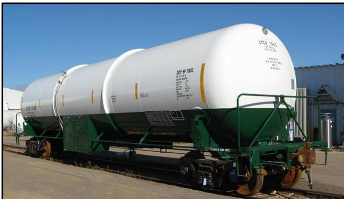
Figura 42 Fotografía carrotanque para líquidos criogénicos DocPlayer, “Transporte, Clasificación y Manejo de Materiales Peligrosos Milagros Fajardo Montiel VSF Industrias SA de CV,” [Online]
