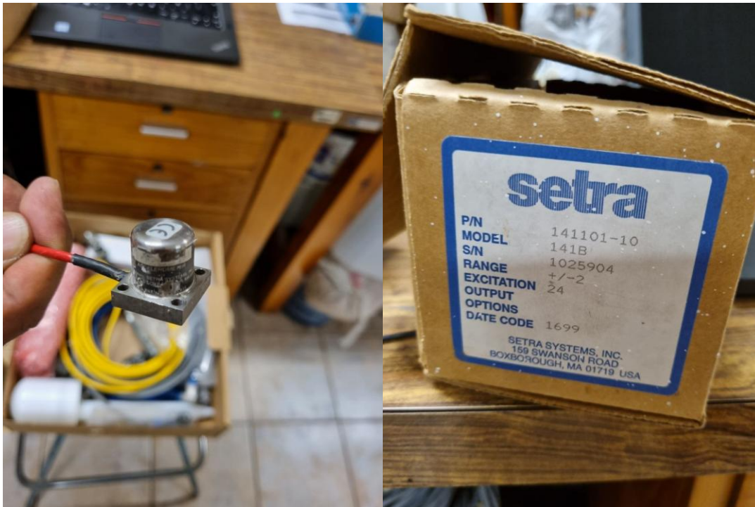
Figura 1.7 Acelerómetro SETRA MOD141B.
