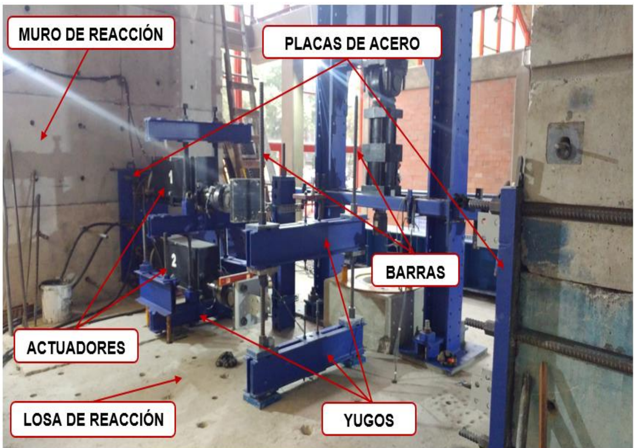
Figura 22. Elementos y equipos utilizados para poder ensayar los especímenes (créditos: Ernesto García).
