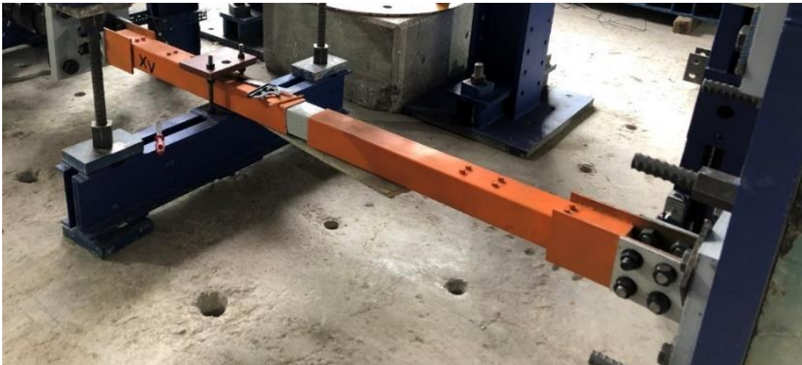
Figura 12. Disipador de energía tipo BRB, propuesto Guerrero (2016).
