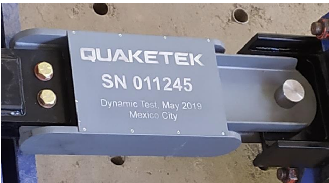
Figura 19. Disipador de fricción marca en el laboratorio (créditos: Ernesto García)
