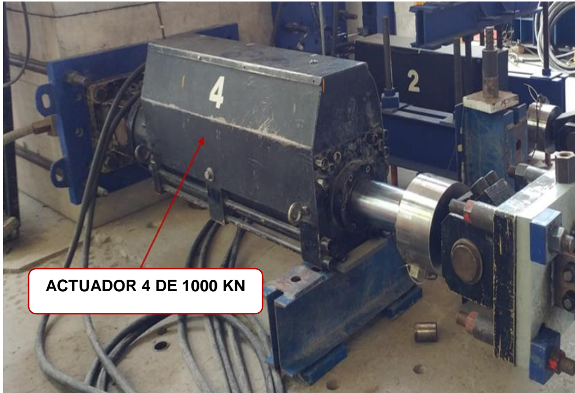
Figura 21. Actuador electrohidráulico 4 de 1000 KN de capacidad (créditos: Ernesto García)
