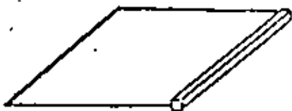
edge beam on a plate
