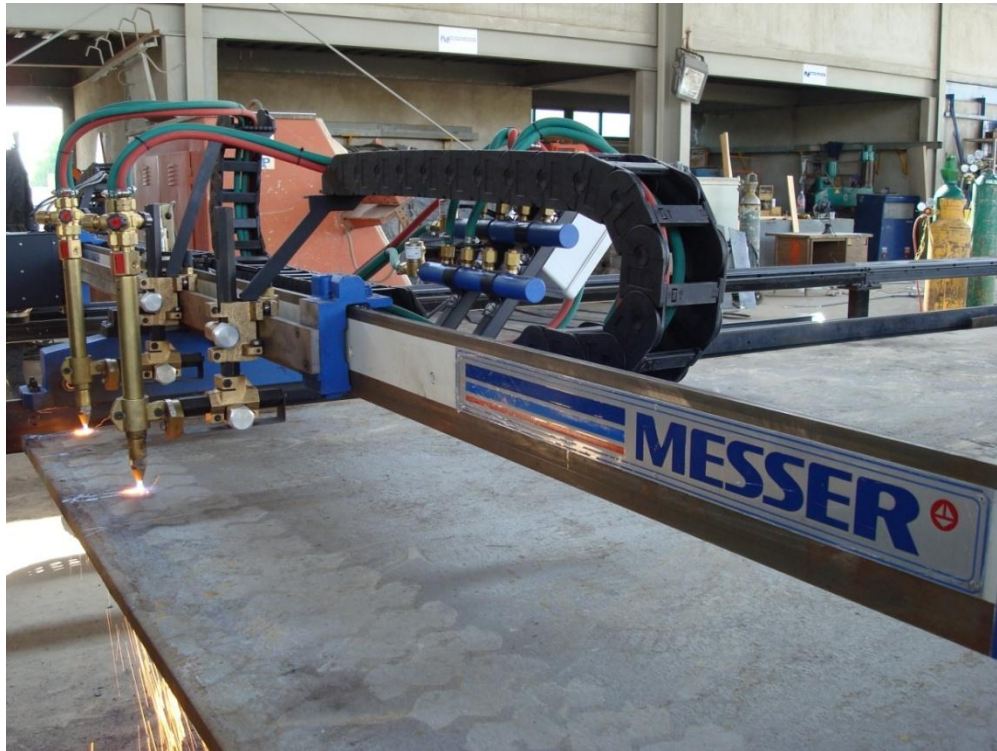
Fotografía 14.- Corte con pantógrafo de la placa.
