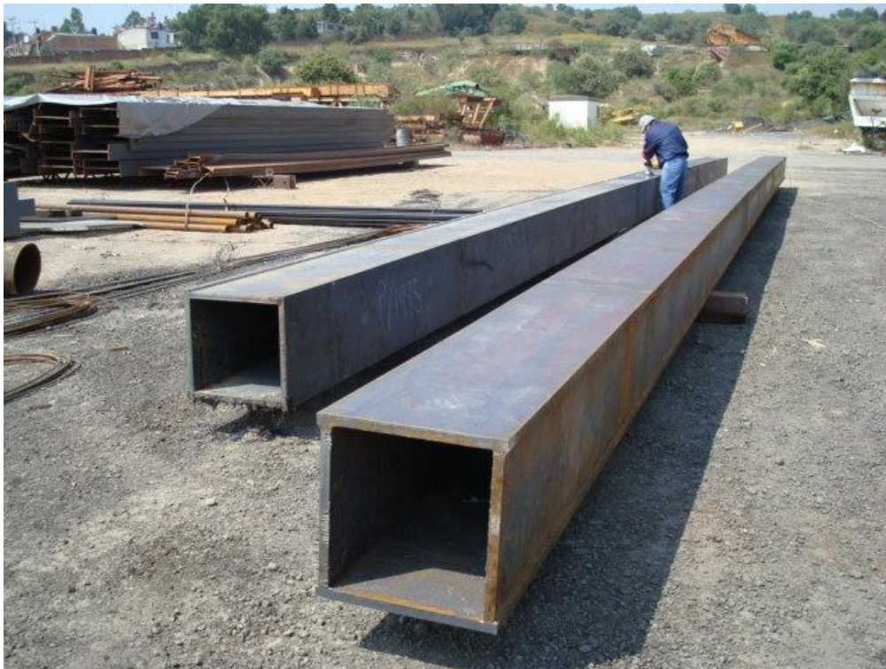
Fotografía 17.- Columnas terminadas listas para embarque a obra.
