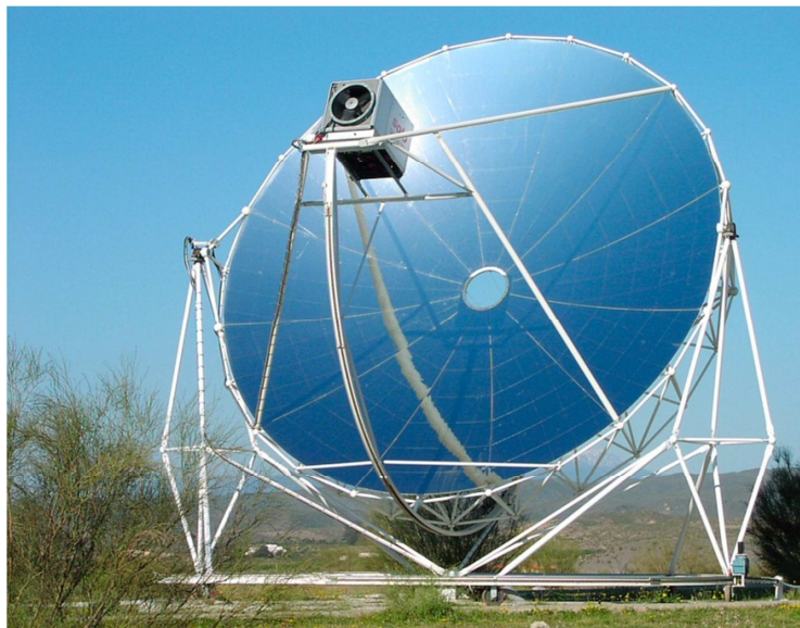
Figura 1.14 Funcionamiento de un disco Stirling. [1.19]
