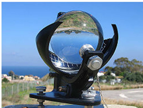
Figura 3.10 Heliógrafo y su funcionamiento. [3.5]
