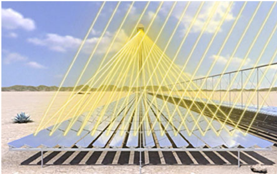
Figura 1.15 Funcionamiento de los colectores Fresnel. [1.18]
