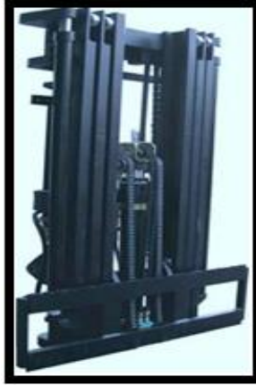
Figura 2.29 Castillo o mástil de un montacargas (Carrasco, 2011)
