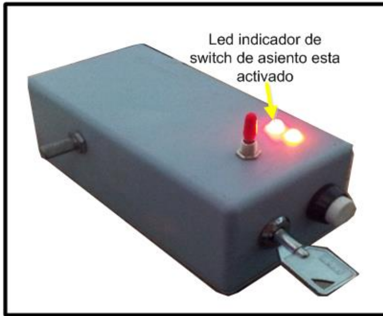
Figura 4.32 Encendido de led al accionar el switch de asiento
