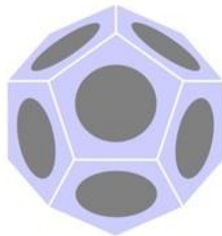
Figura 3.1. Representación pictórica de una fuente omnidireccional del tipo dodecaedro.
