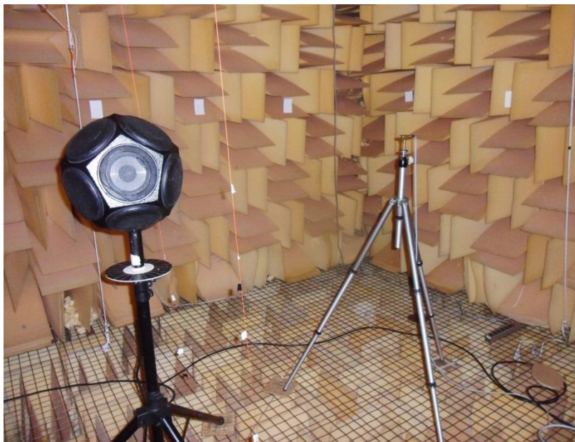
Figura 3.20. Caracterización de la fuente omnidireccional sonora en la cámara anecoica.
