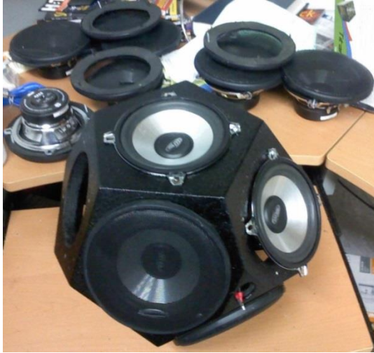
Figura 3.5. Ensamble y conexión de altavoces en el dodecaedro.
