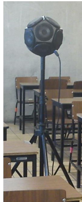
Figura 3.8. Fuente omnidireccional terminada.
