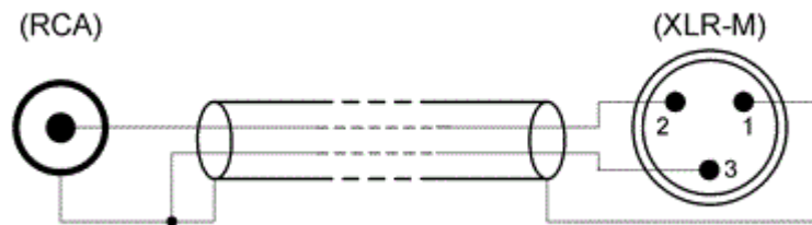
Figura 3.10. Conexión RCA a XLR desbalanceada.
