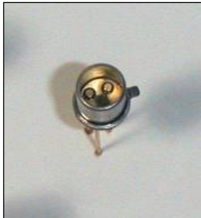
Figura 2.11 SVTA-UV-A fotodetector [ref.20]
