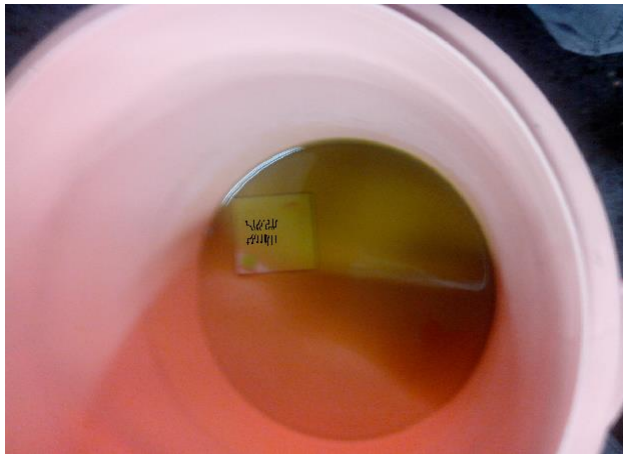
Figura 2.18 Tratamiento con cloruro férrico de la tableta
