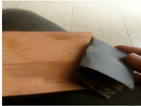
Figura 2.17 Lijado de la placa fenólica
