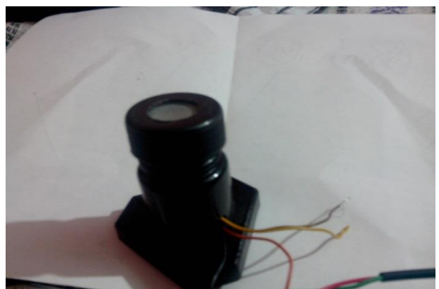
Figura 3.8 Sensor UV-A con cubierta de vidrio.
