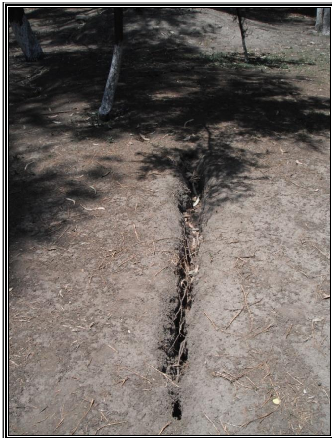
Figura 3.92. Fotografía que muestra una discontinuidad en el suelo de las áreas verdes en la Alameda Norte, Pueblo Santa Bárbara.
