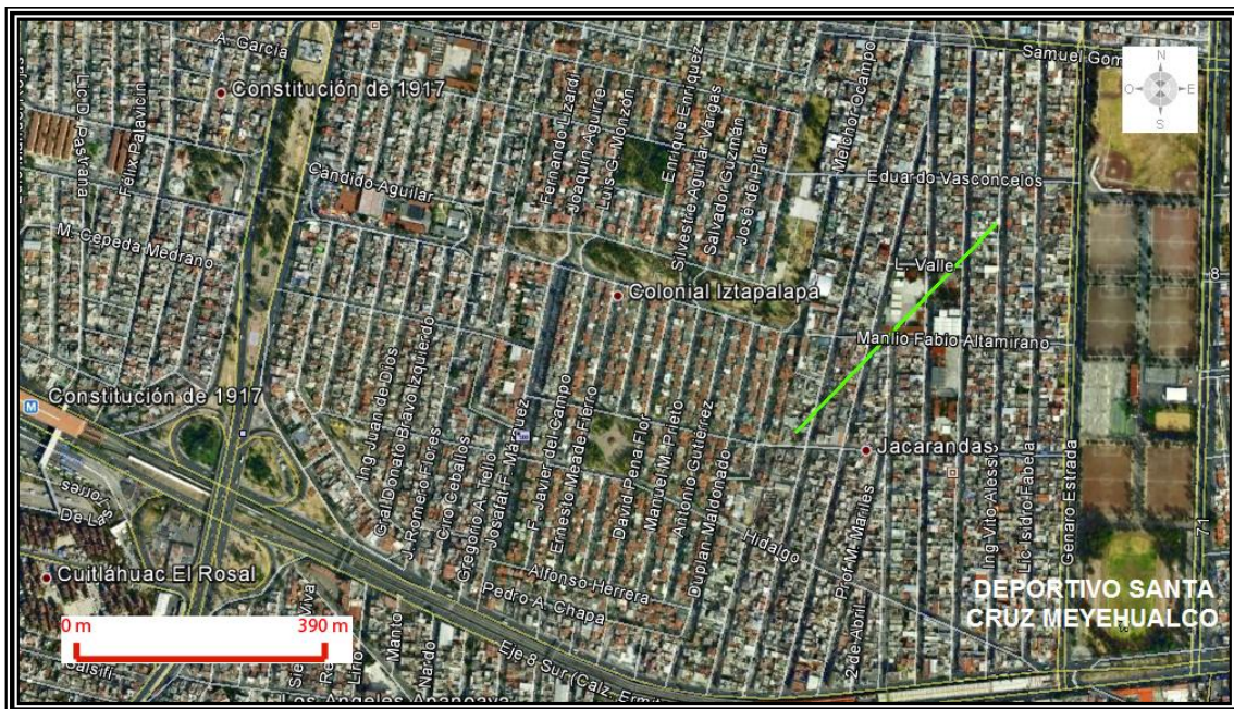
Figura 3.51. Imagen que muestra las fracturas representadas en una imagen de Google Earth, en la colonia Jacarandas.
