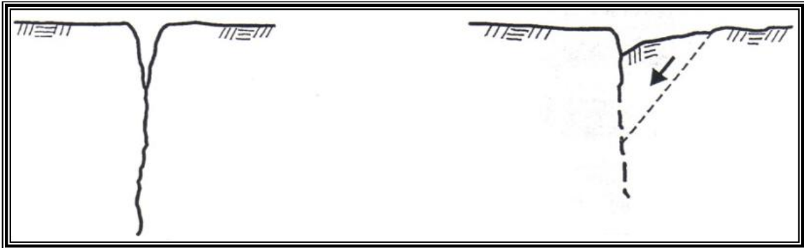
Figura 3.5. Fractura aislada, antes (izq.) y después (der.) de lluvia o de un sismo (Romero, 2011).
