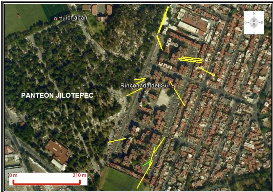
Figura 4.45. Ubicación de las fracturas y fallas representadas en una imagen de Google Earth, en la colonia Huichapan. Las líneas amarillas corresponden con fracturas y las verdes con fallas.
