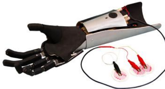
Figura 2.13 Prótesis mioeléctrica con electrodos. [15]
