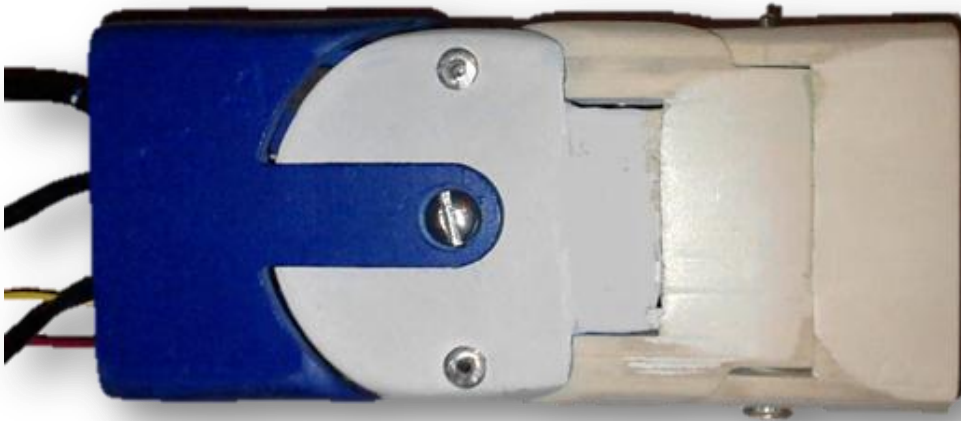
Figura 5.5 Modelo de prótesis de muñeca, vista dorsal.
