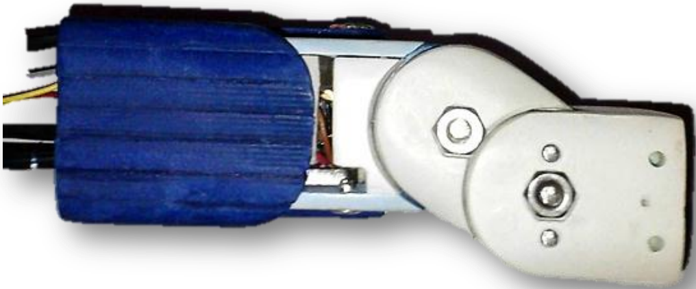
Figura 5.10 Movimiento incorrecto del modelo, la pieza flexoextensión 1 está en su máxima extensión mientras la pieza flexoextensión 2 se encuentra en su máxima flexión.
