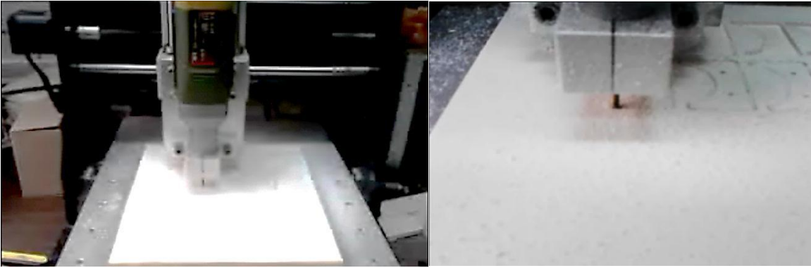
Figura 5.4 Maquinado en el minrouter CNC .
