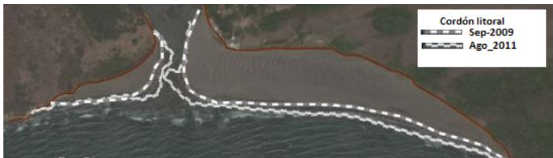
Figura 12.-Evolución de la boca por desplazamiento por traslape ( overlapping offset ) según la clasificación de Galvin (1971).
