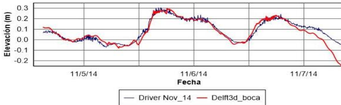
Figura 79.- Validación de la marea en laguna la mancha utilizando el modelo Delf3d con datos de medidos en la boca de laguna La Mancha en noviembre del 2014.
