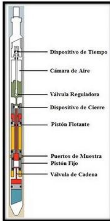
Figura 2.13. Muestreador, herramienta que se usa para tomar la muestra en el fondo del pozo. 18
