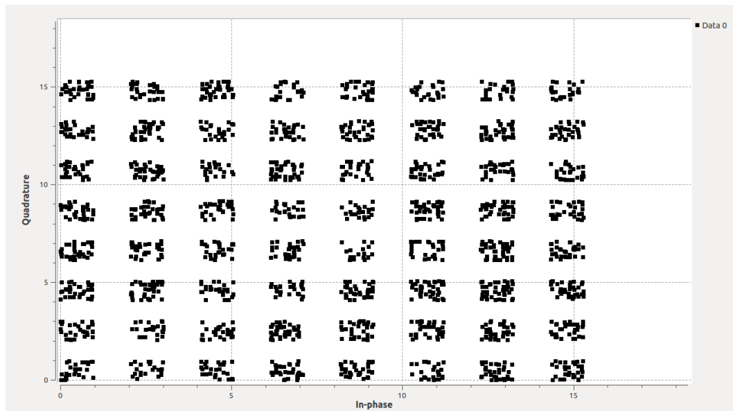
Figura 6.20: Constelación de una señal de ATSC obtenida a través de GNU Radio.
