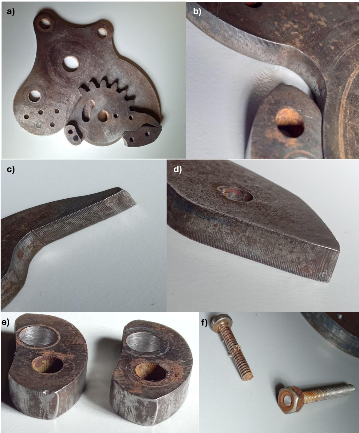
Figura 17: Fotografías que muestran el desgaste y diferentes tipos de fallos de ciertos elementos del sistema de-pinzas de cavitación después de un largo periodo de pruebas: (a) vista general de la pinza-engrane, la placa base y los amortiguadores; (b) zona de impacto entre los amortiguadores y la placa base; (c) punta de la pinza engrane; (d) base de la pinza; (e) los pares de amortiguadores; (f) tornillos donde se apoyan los resortes.
