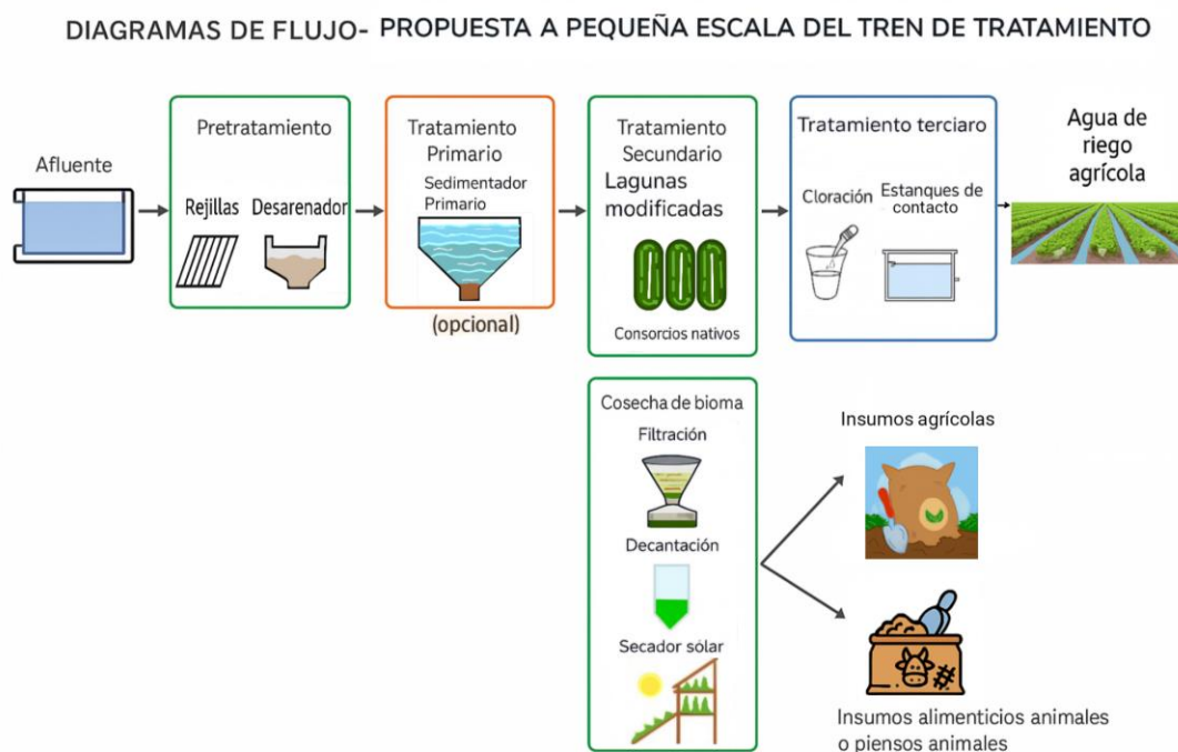
Figura 33. Diagrama de flujo del tren de tratamiento propuesto a escala pequeña, autoría propia
