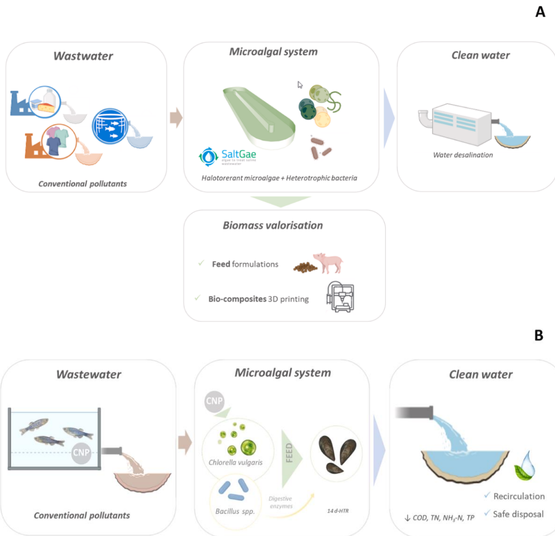
Figura 32. Diagramas de flujo del proyecto SaltGae caso A y B, (Amaro et al., 2023).
