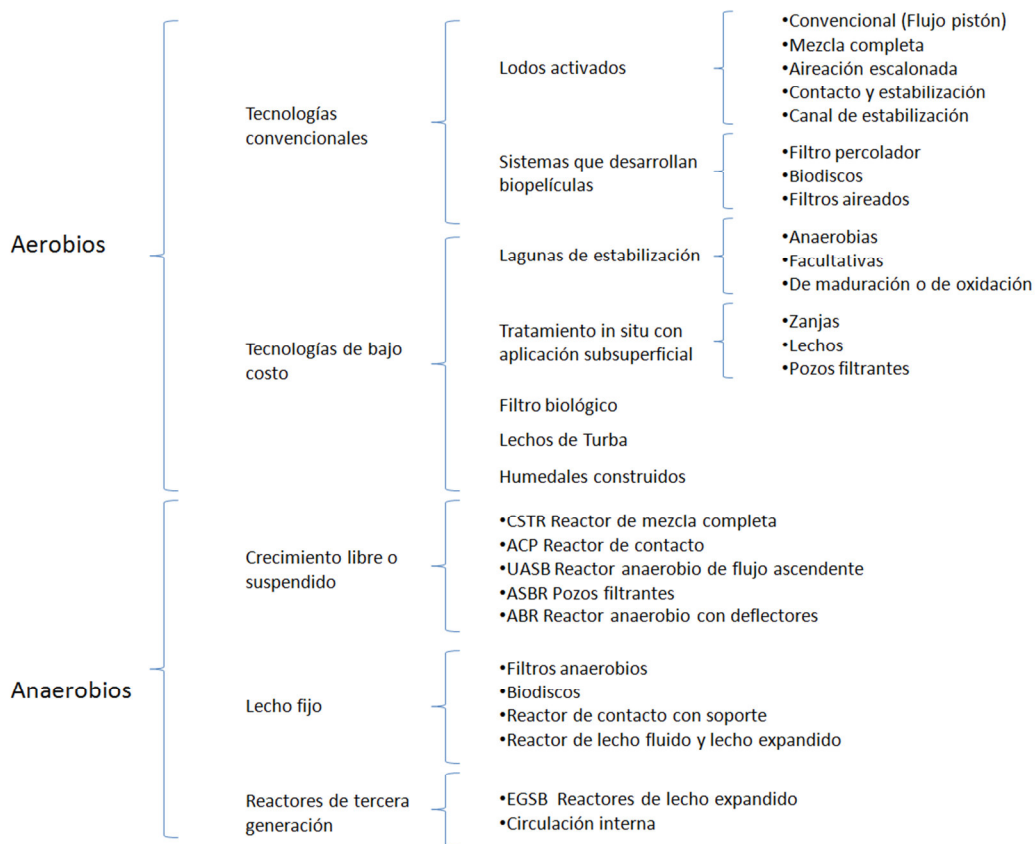
Figura 2.1 Clasificación de procesos de tratamiento biológico de agua residual. Adaptado de Metcalf & Eddy (2004).
