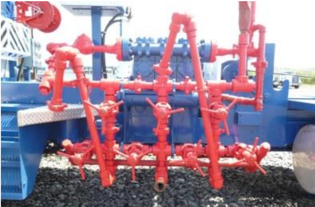
Figura 2.26 Múltiple de Estrangulación
