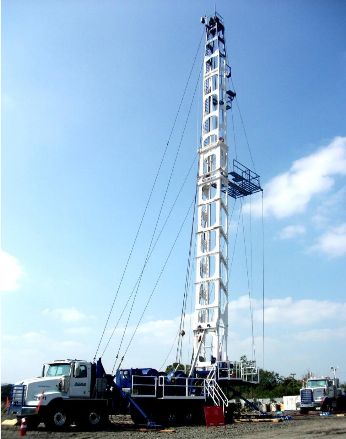
Figura 2.2 Unidad Móvil de Servicio o Mástil
