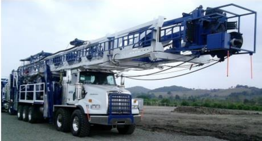
Figura 2.5 Unidad Móvil de Servicio o Mástil
