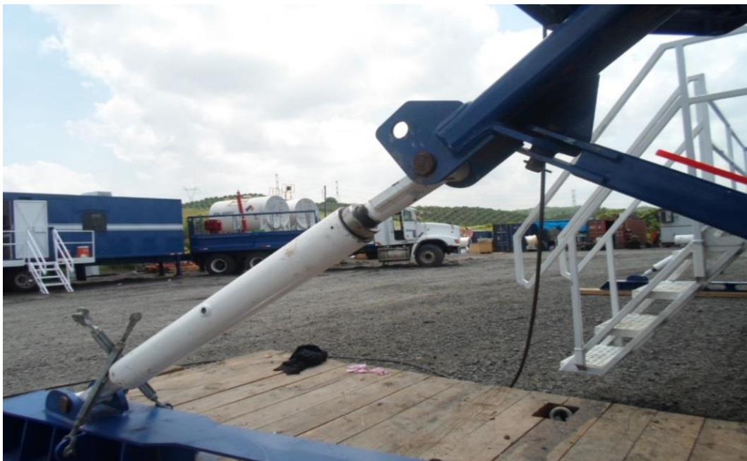
Figura 2.6 Sistema de Estabilizadores
