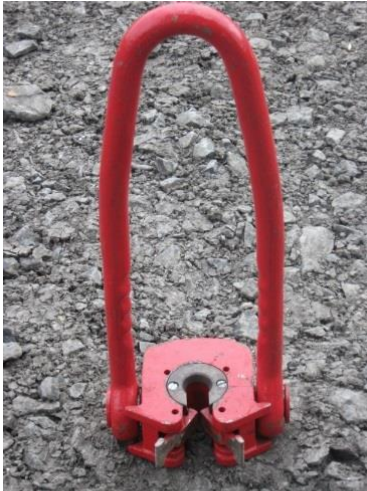
Figura 2.16 Elevador para varilla de bombeo
