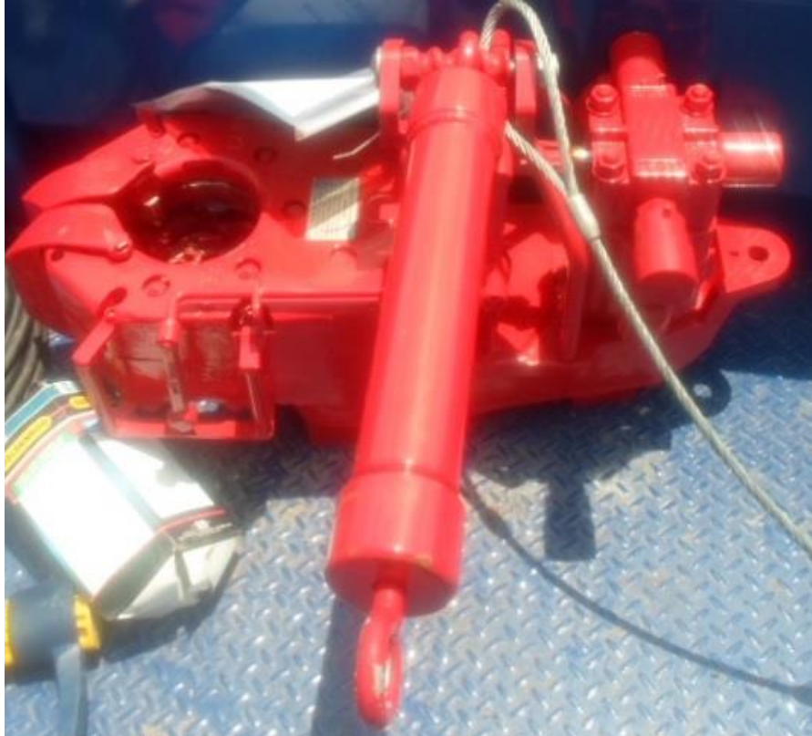
Figura 2.18 Llave para Varilla de Bombeo
