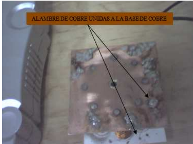
Figura 3.14: Ensamble final del estator
