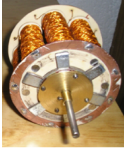
Figura 3.15: Vista del rotor superior en los dos motores diseñados
