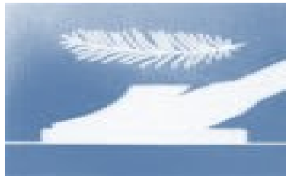
Figura 2.9.- Baja presión de la campana sobre la piel para la detección de sonidos de baja frecuencia.
