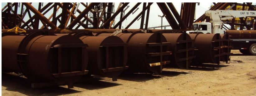
Figura 2.21. Tanques de flotación.
