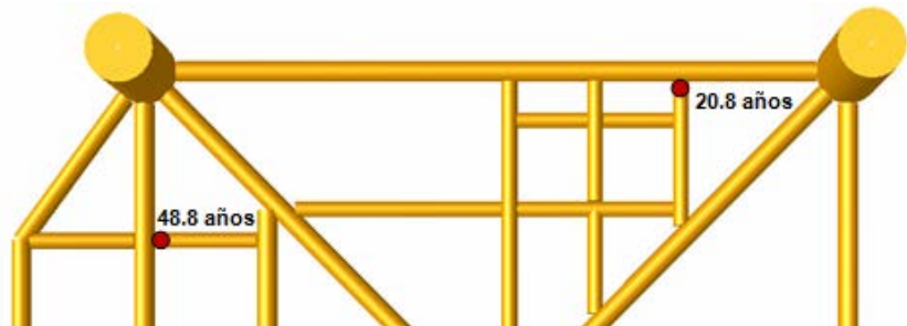
Figura 5.25. Ejemplo de conexiones con menor tiempo de vida calculada (SACS).
