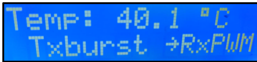
Figura 3.21: Menú principal de la interfaz del dispositivo. El carácter de la flecha es el cursor de la interfaz para seleccionar los otros dos menús.
