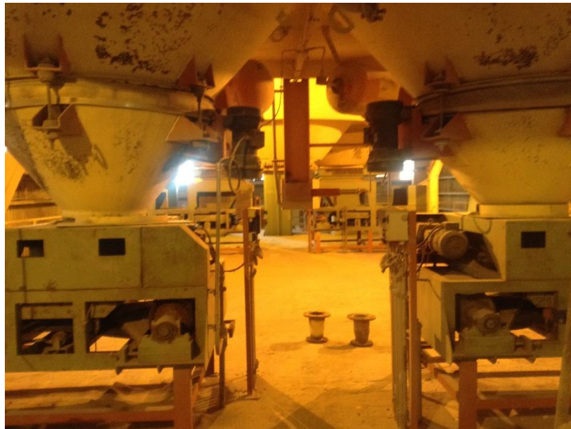
IMAGEN 4.7.3.2. DOSIFICADORES DE MATERIAS PRIMAS, PARA MOLIENDA DE HARINA CRUDA.
