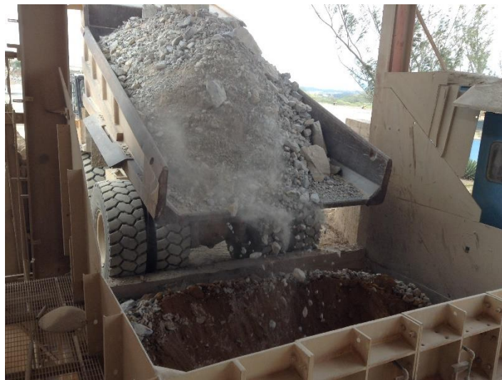
IMAGEN 4.3.2.1. TRITURACIÓN MATERIA PRIMA, TRITURACIÓN PRIMARIA.
