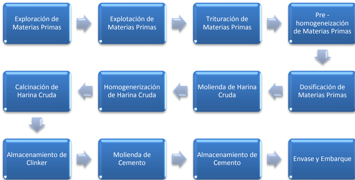
DIAGRAMA 4.1. PROCESO DE ELABORACIÓN DEL CEMENTO CRUZ AZUL.
