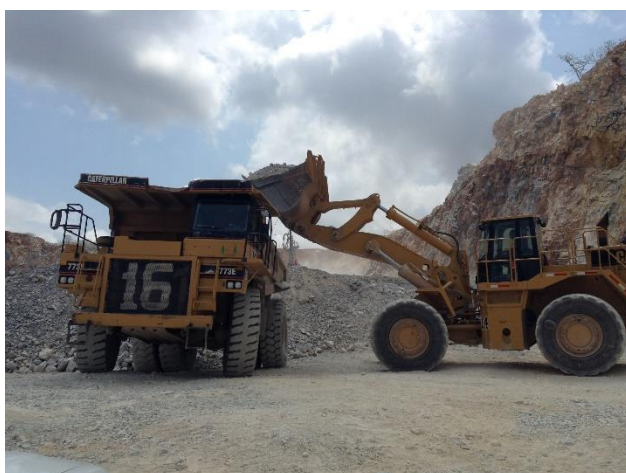
IMAGEN 4.2.2.1. CARGA Y ACARREO DE MATERIA PRIMA.
