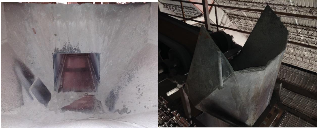
IMAGEN 7.3.7. CABEZAL CONDUCCION DE PERFIL ESTRUCTURAL.
