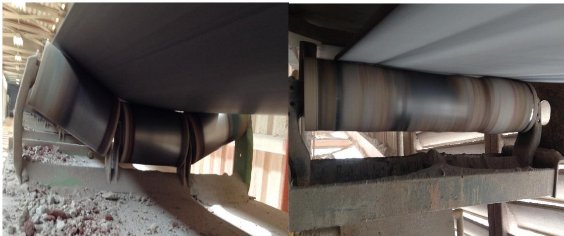
IMAGEN 7.3.4. RODILLOS DE CARGA Y RETORNO PARA BANDA TRANSPORTADORA.
