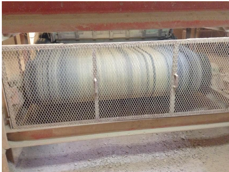
IMAGEN 4.3.2.3. BANDA TRANSPORTADORA, DIRECTO A TOLVAS. TRITURACIÓN PRIMARIA.
