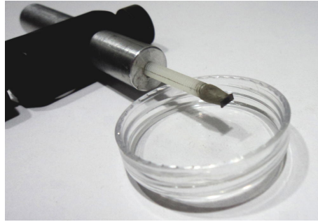
Figura 5.6: Película de acoplamiento sujeta a un soporte de teflon, con la finalidad de alterar el sistema en menor medida.
