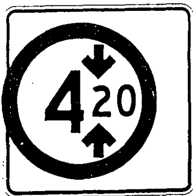
SR-15 ALTURA LIBRE RESTRINGIDA
