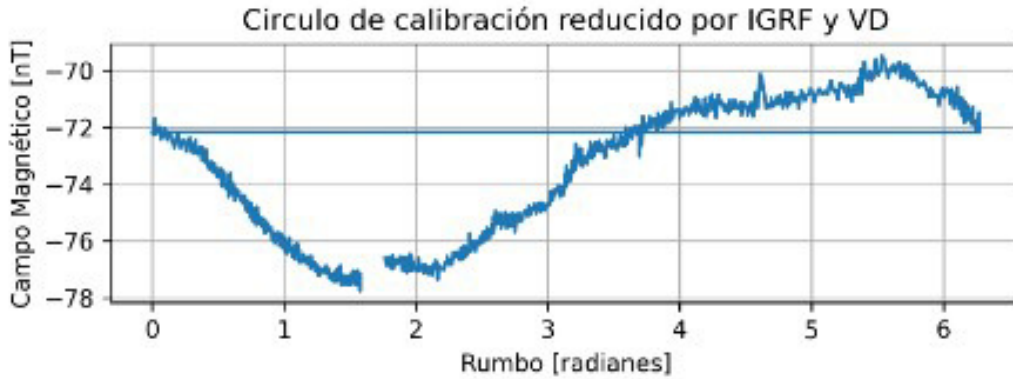
Figura 29. Registro magnético del círculo de calibración, reducido por IGRF y variación diurna, en función del rumbo del buque.
