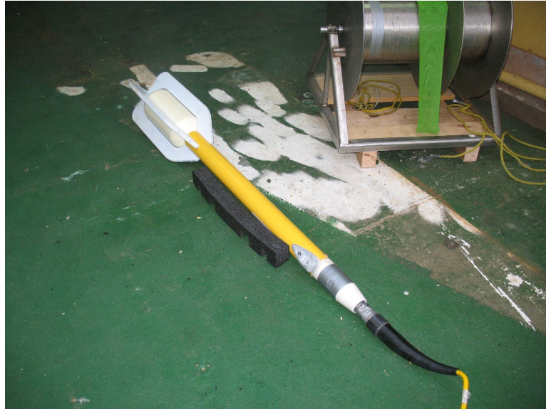
Figura 18. Magnetómetro marino Geometrics G 877.
