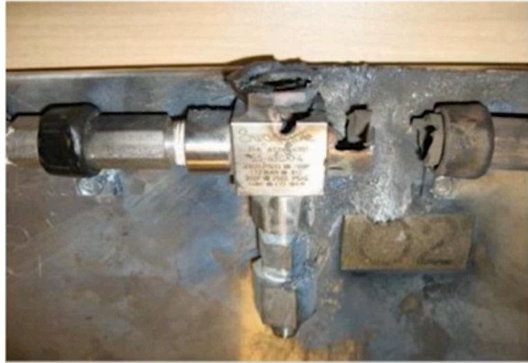
Figura 7. Válvula Swagelok para oxígeno, quemada por ignición [58].
