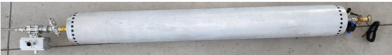
Figura 41. Tanque de oxidante con OTDM y OTUM con MOV neumática.
