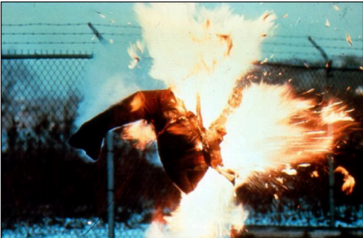
Figura 8. Muñeco de prueba tras una falla debido a la inflamabilidad de un material [45].
