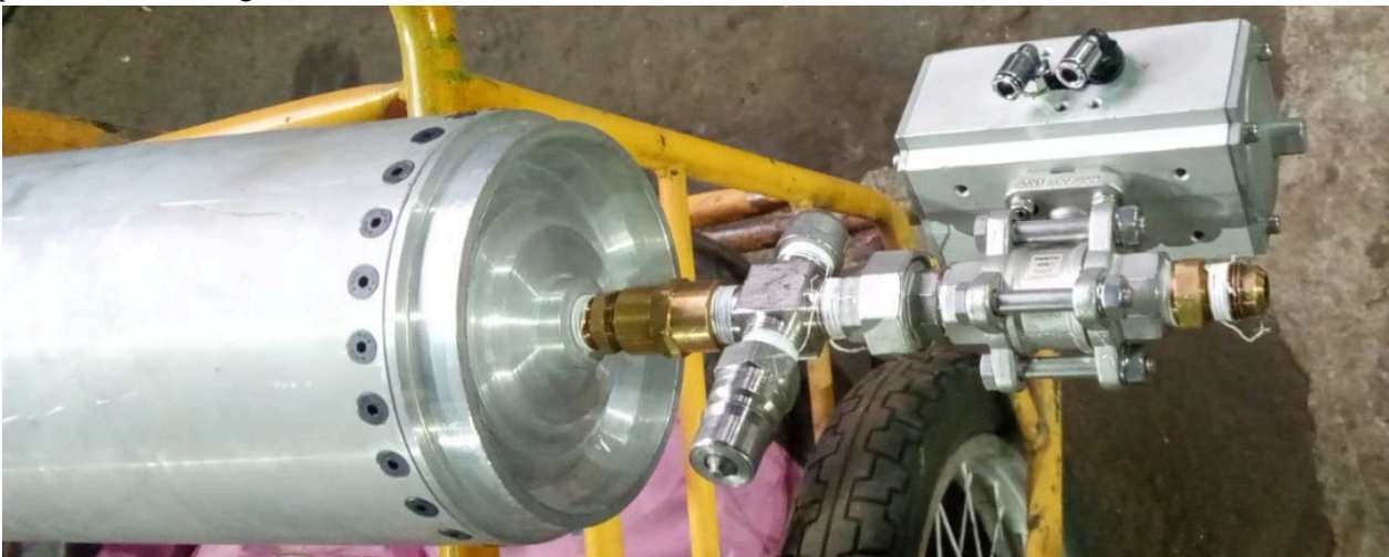
Figura 42. Ensamble Tanque de oxidante con OTDM y MOV neumática.
