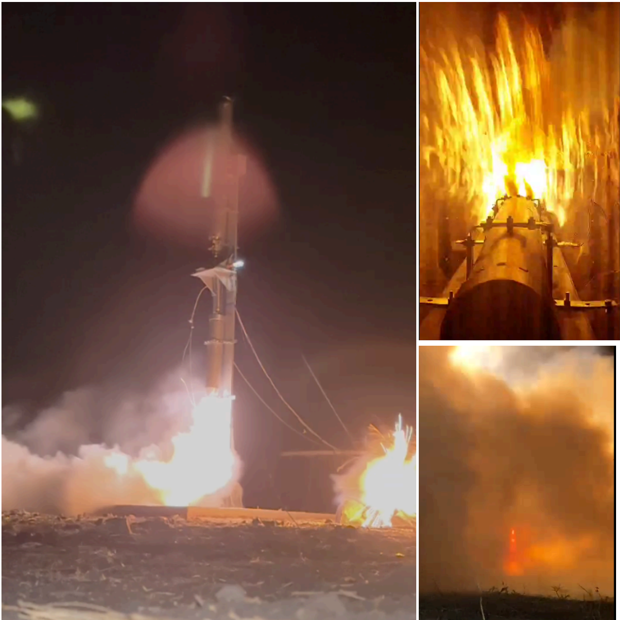
Figura 59. Prueba castigador 2. Izquierda: apertura MOV. Derecha abajo: cámara lejana se aprecian “ shock diamonds ”. Derecha arriba: Vista superior.
