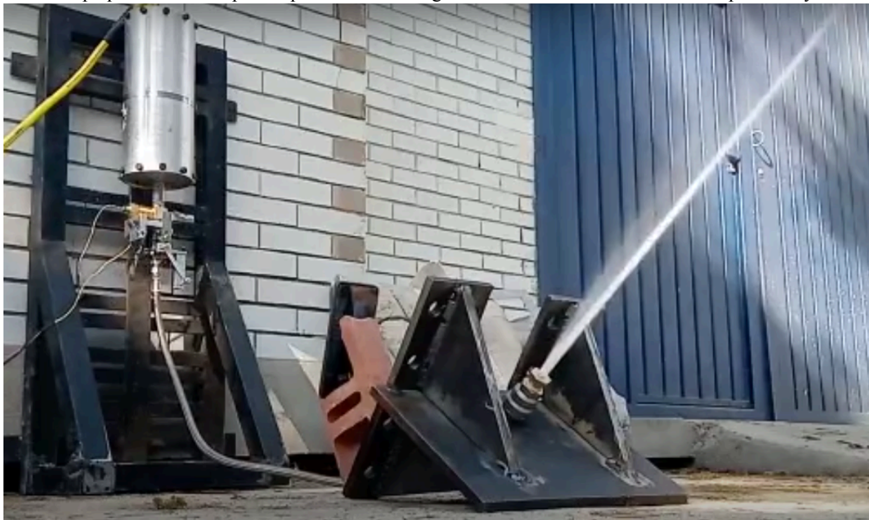
Figura 50. Primera prueba de flujo frío con agua con sistemas provisionales.
