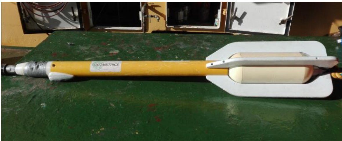
Figura 7. Magnetómetro marino modelo G-877 de precesión protónica utilizado durante la campaña PERDIDO-2, marca Geometrics.
