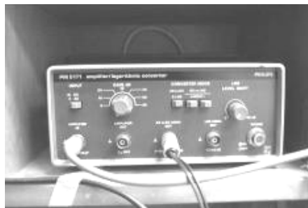
Figura 2.6 Amplificador logarítmico, PM5171, y medidor de voltaje de C.A. RMS a voltaje de C.D.
