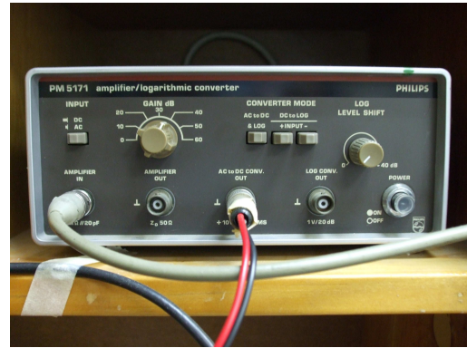
Figura 3. Amplificador logarítmico salida DC proporcional a voltaje RMS de señal de AC a la entrada
