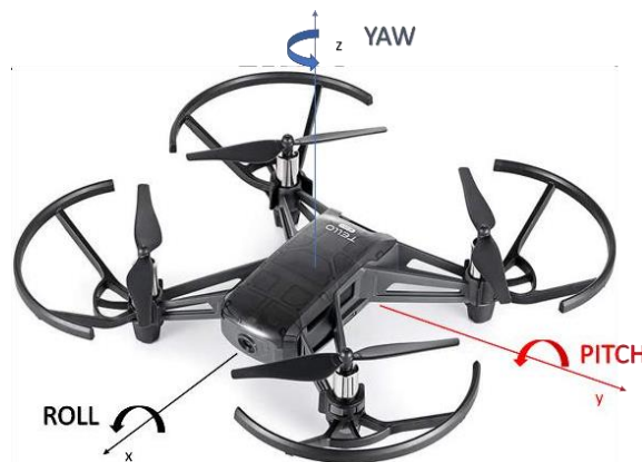
Figura 4. Representación de los movimientos del dron en un espacio tridimensional
