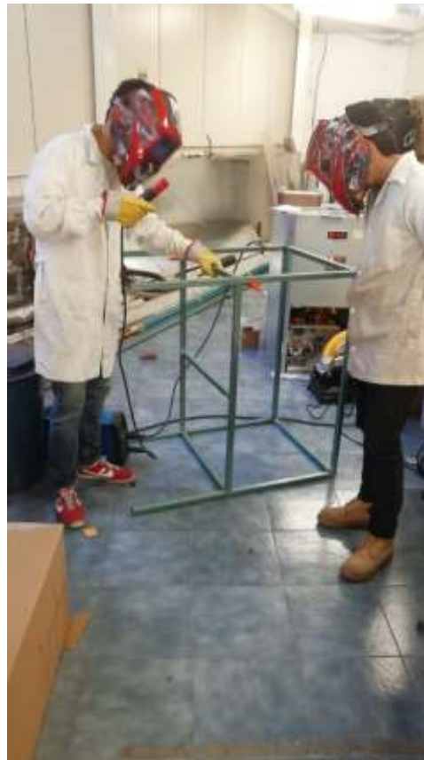
Imagen 138 Proceso de soldar la estructura de PTR
