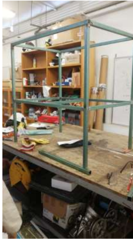
Imagen 139 Estructura final de PTR para la BCG 3 TR
