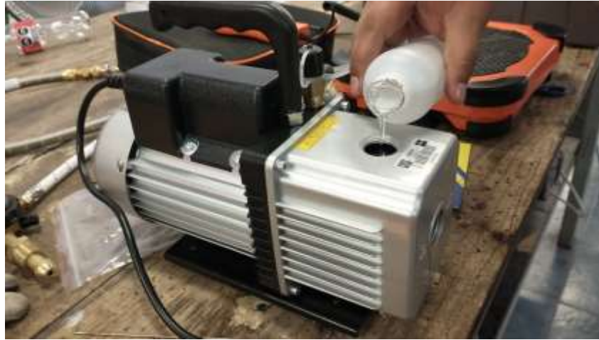
Imagen 156 Llenado de aceite a la bomba de vacío
