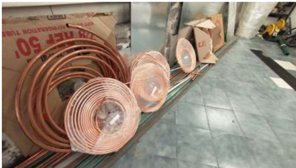
Imagen 122 Rollos de tubería de cobre tipo L
