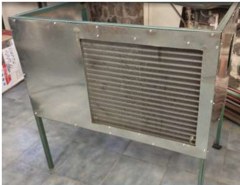
Imagen 146 Intercambiador de tubos y aletas montado en estructura de la BCG 3 TR
