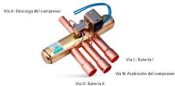
Imagen 28 Válvula de cuatro vías (Ibérica, 2016)
