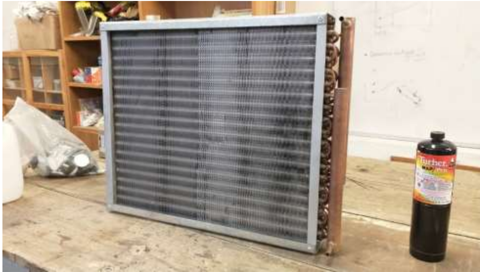
Imagen 145 Intercambiador de calor de tubos y aletas que funcionará como evaporador o condensador dependiendo la configuración de la BGC 3 TR
