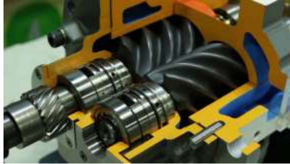
Imagen 20 Compresor de tornillo (IRIM, 2015)
