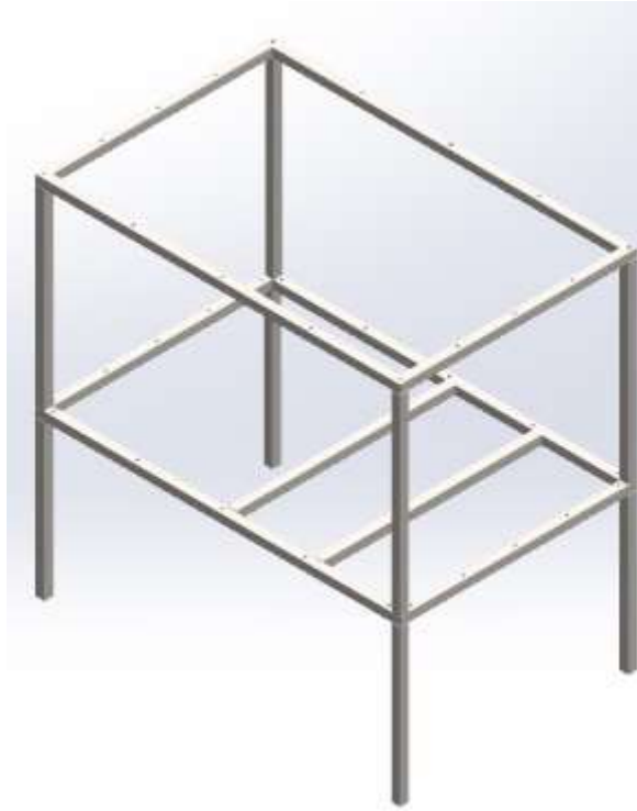
Imagen 127 PTR con el que se forma la estructura de la BCG 3 TR (elaboración propia)
