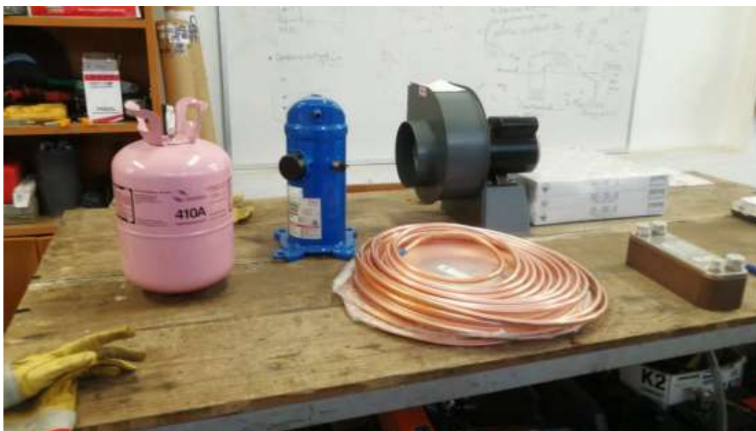
Imagen 143 Algunos de los equipos que van en el interior de la BCG
