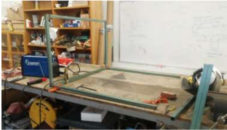
Imagen 137 Estructura de PTR calibre 16 1"x 1" para la BCG 3 TR
