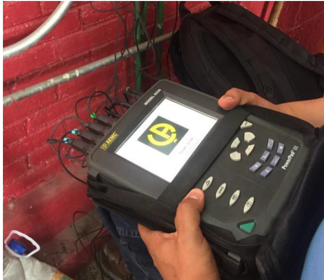
Figura 2.4 Analizador de calidad de energía AEMC 8336
