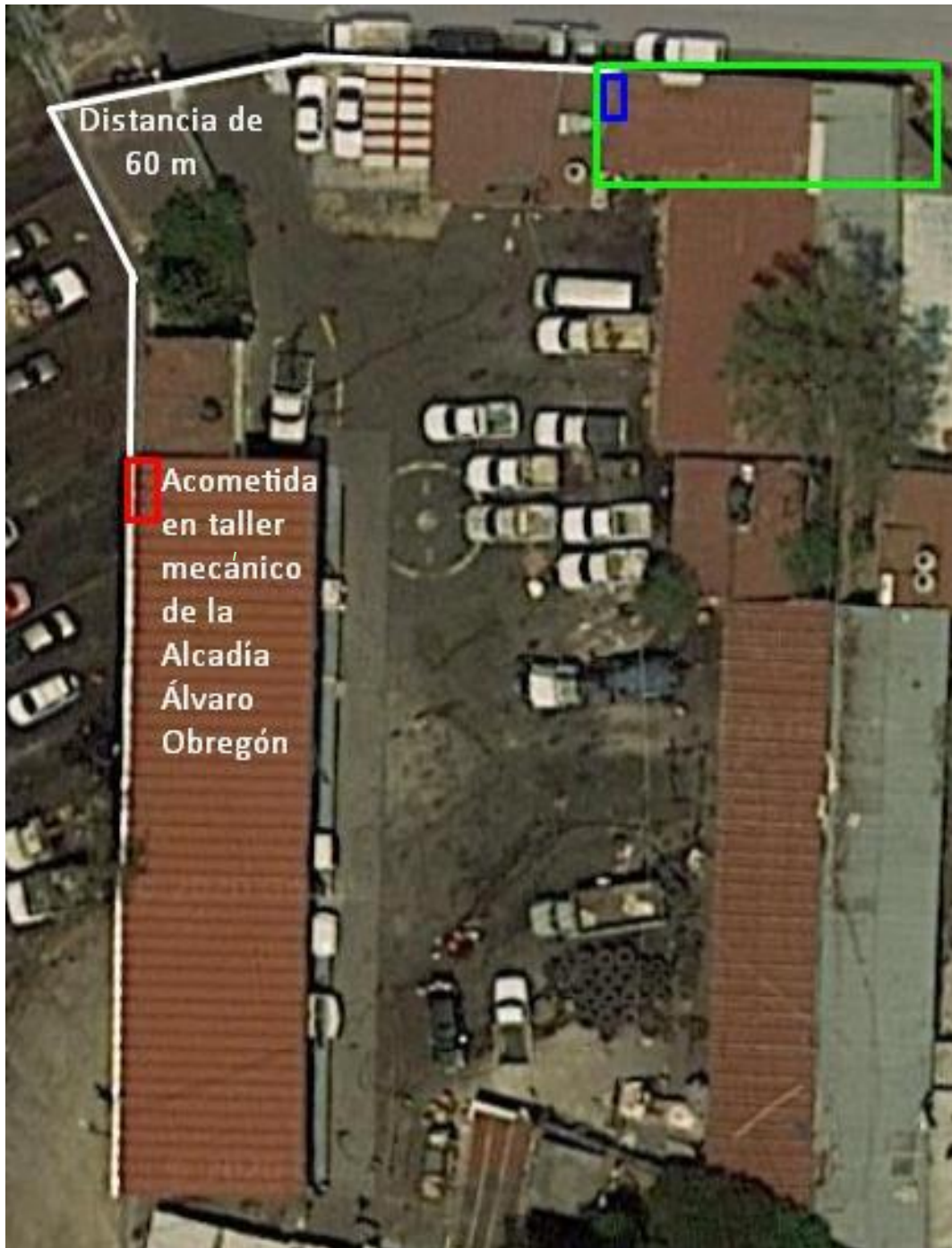
Figura 2.8 Representación por plano del recorrido de cableado de la acometida al panel eléctrico de la planta de biodiésel
