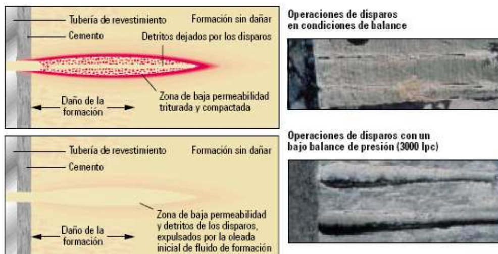
Figura 2.20. Operaciones de disparos con sobre balance y bajo balance de presión. ©Schlumberger.
