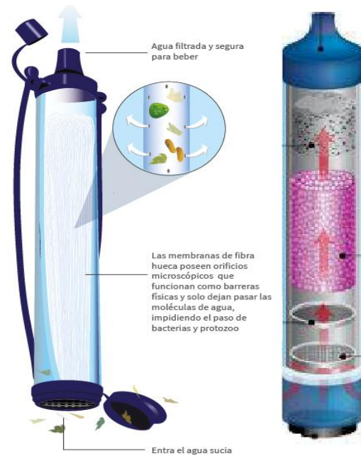
Figura 2.13 Esquema del LifeStraw®.
