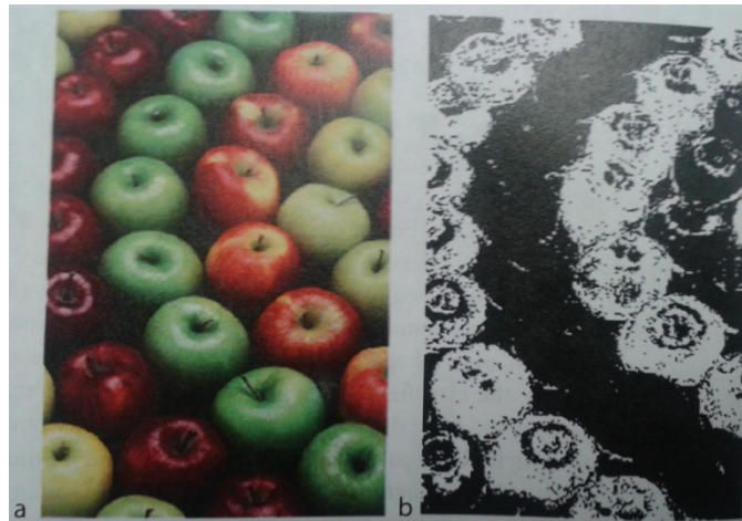
Fig. 2.6 Resultado del uso del clasificador de conjunto (CC) para reconocer manzanas rojas
