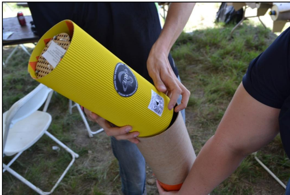
Fig. 113. Integración del CanSat dentro del cohete
