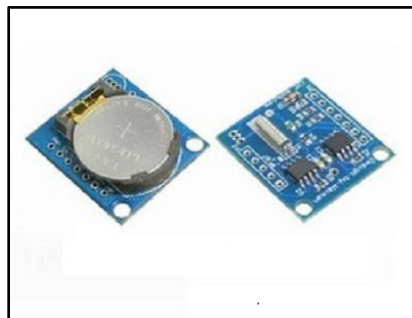
Fig. 77. Módulo RTC con interfaz I2C
