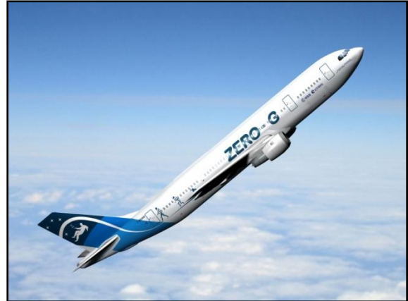
Fig. 130. Avión Zero G de Novespace, utilizado para realizar vuelos parabólicos. Crédito: ESA
