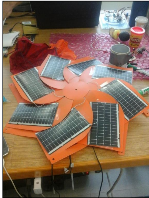
Fig. 83. Ocho paneles solares flexibles sobre el control de descenso de la carga útil
