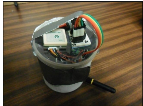
Fig. 31. Prototipo de CanSat integrado en una lata.
