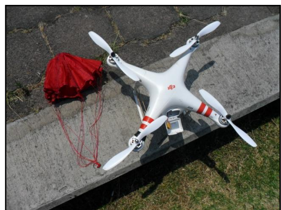
Fig. 105. Helicóptero y paracaídas utilizados para las pruebas de velocidad de descenso
