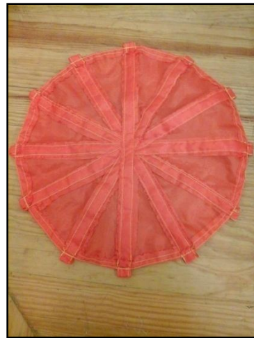
Fig. 71. Paracaídas circular de 17 cm de radio
