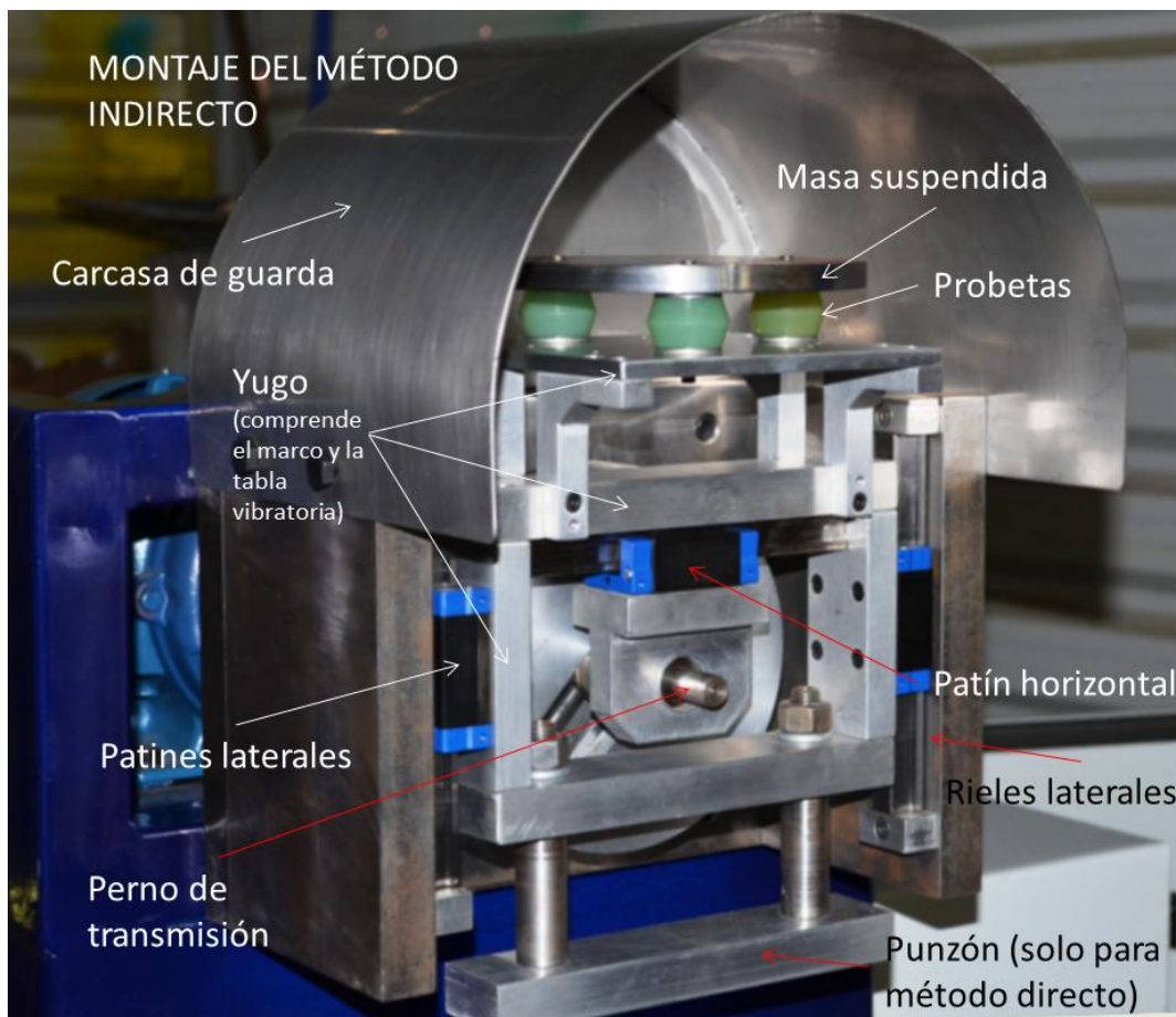
Figura 6-1. Nombres de las piezas del banco con el montaje de la caracterización por medio del método indirecto.
