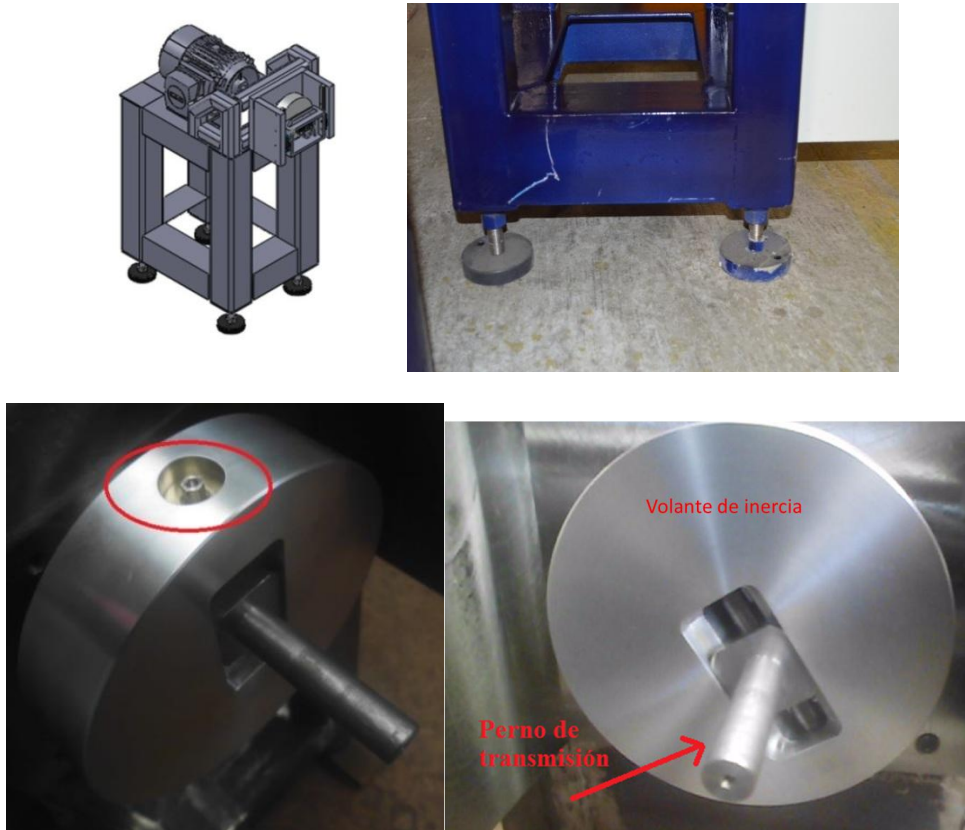
Figura 5-6. A la izquierda superior se muestra el diseño realizado por el taller de manufactura. A la derecha superior están los soportes que se apoyan y se empotran en el piso. Las imágenes de abajo muestran el tornillo sujetador que al girarlo cambian la excentricidad del perno de transmisión.
