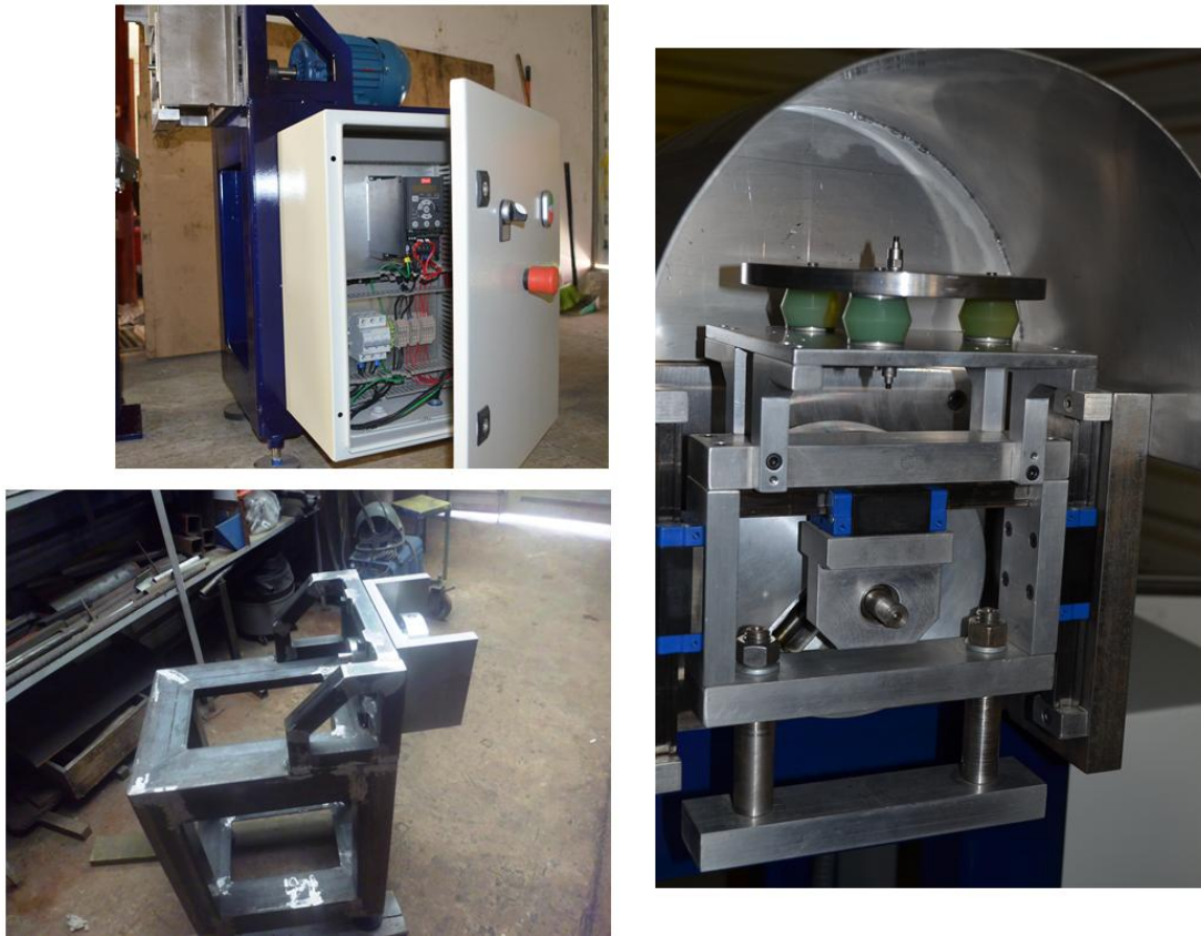
Figura 5-10. La imagen superior izquierda muestra la caja de la circuitería eléctrica para el control de la velocidad del motor. La imagen inferior izquierda muestra la estructura del banco. La imagen de la derecha muestra el ensamble para el método directo de medición, las probetas y la masa suspendida.
