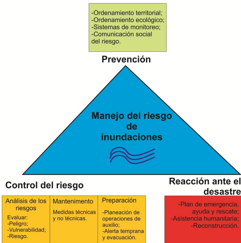
Figura 1.5 Esquema general de los procesos involucrados en el manejo del riesgo de inundaciones (Pedrozo-Acuña, 2012).
